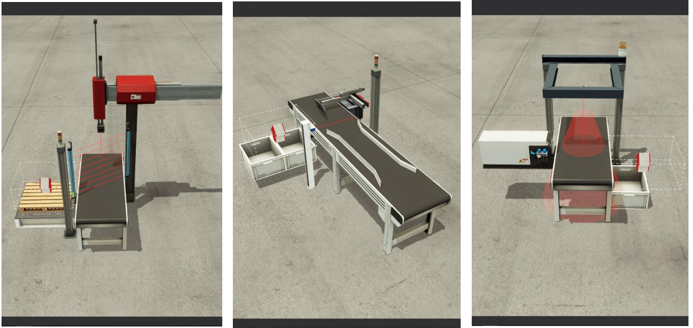
Il·lustració 12. De esquerra a dreta, els sistemes de rebuig de les cintes C1, C2 i C3. Procedència: Elaboració pròpia
