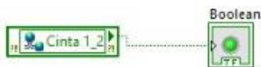
Il·lustració 30. Variable vinculada a un booleà en LabVIEW. Procedència: Elaboració pròpia
