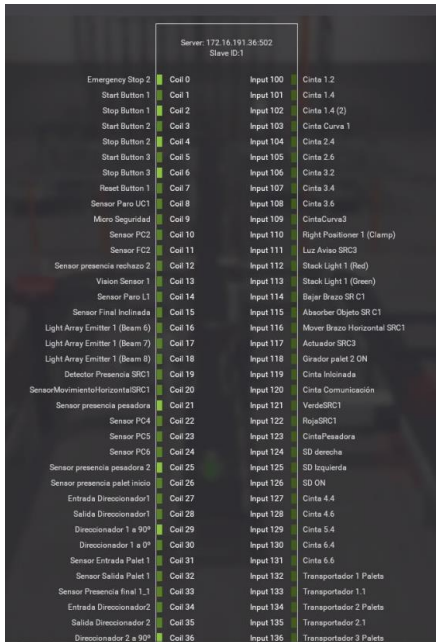
Il·lustració 6. Adreçar variables a posicions de memòria (Factory). Procedència: Elaboració pròpia
