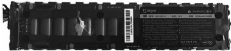
*Figura 2.7. Paquete de baterías de un patinete Xiaomi Mijia M365*
