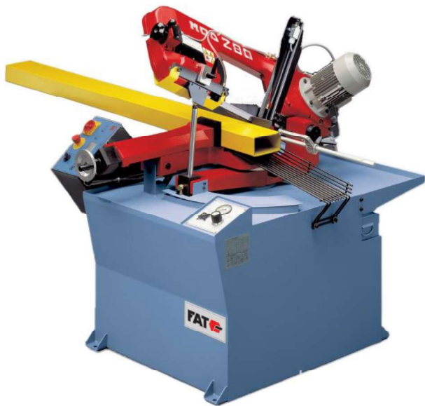
Ilustración 1. SIERRA SEMIAUTOMÁTICA MODELO 280 SA 60 o FAT
