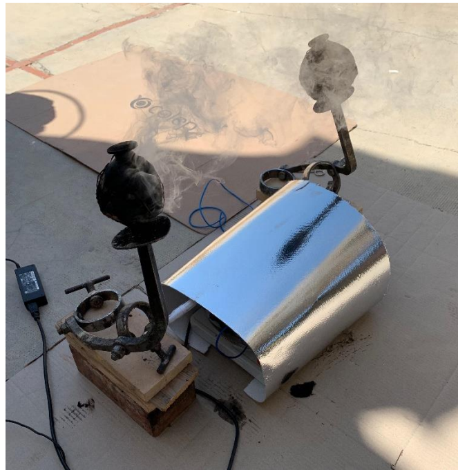
Figura 38: Pantalla de protección de aislante térmico reflectante.
