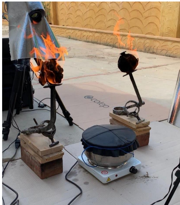
Figura 34: Instalación experimental. Recipiente expuesto a la radiación de los focos de calor.
