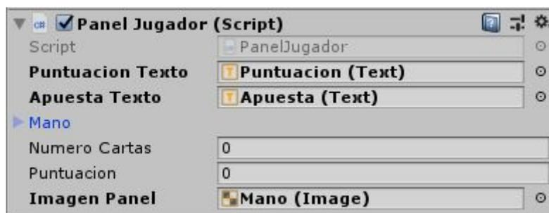
Figura 22: Configuración de la clase PanelJugador para cada jugador.
