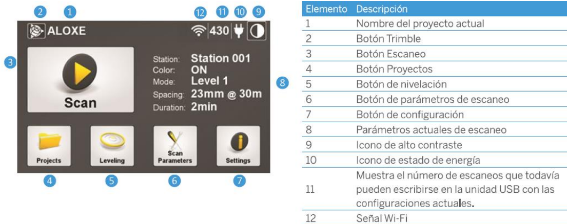
Figura 5: Pantalla del Trimble TX6.
