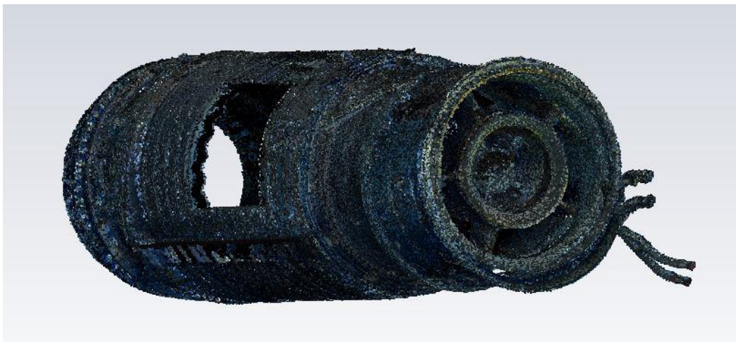
Figura 56: Resultado final de la nube de puntos del post-combustor.
