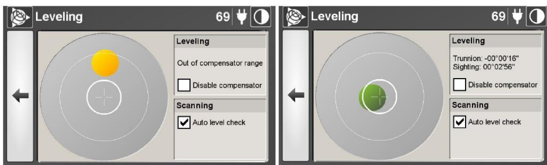
Figura 6: Nivelación del Trimble TX6.
