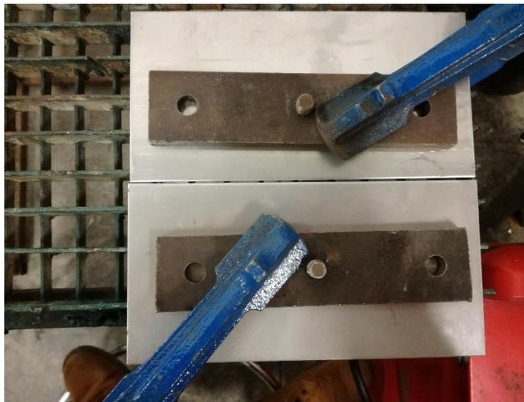
*Figura 16. Preparación previa a la soldadura de las chapas de acero AISI 304L*
