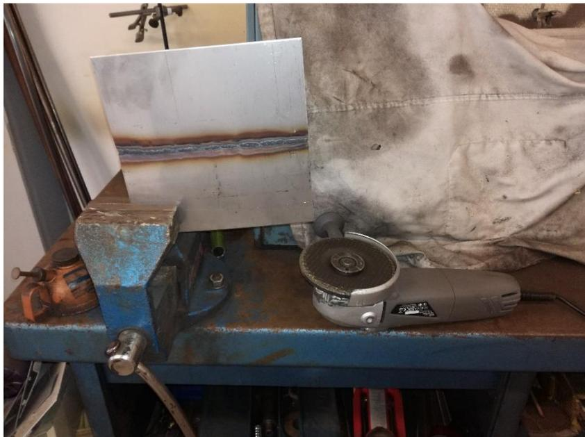
*Figura 18. Procedimiento para retirar el material sobrante de la soldadura*
