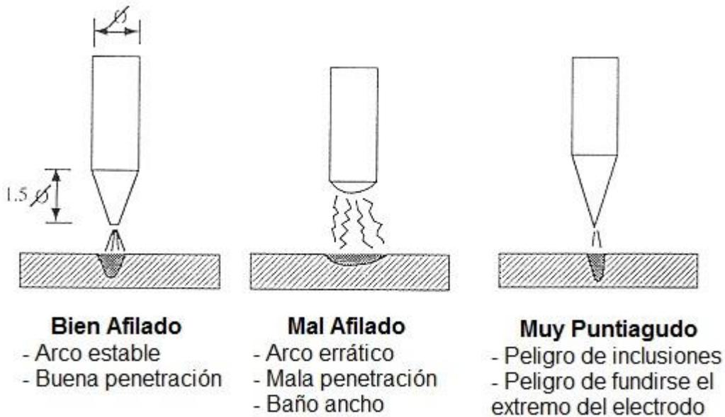
Figura 11. Influencia del afilado del electrodo en la calidad de la soldadura.
