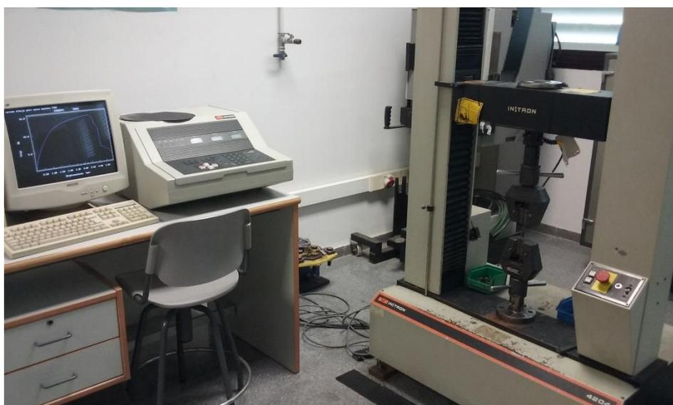
Figura 23. Prensa hidráulica, tambor y ordenador empleado en el ensayo de tracción de las probetas.
