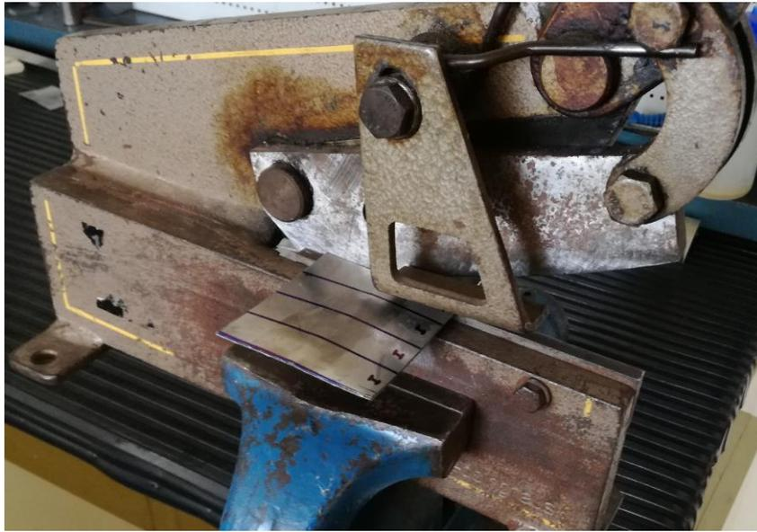
*Figura 21. Proceso de corte mediante la cizalla de las probetas realizadas*
