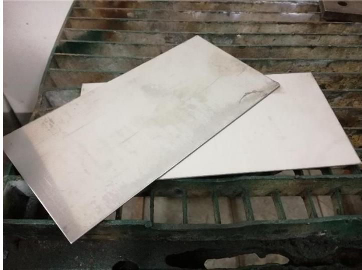
*Figura 15. Chapas de acero AISI 304 L*
