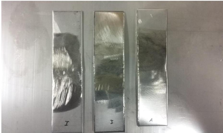
*Figura 22. Muestra de probetas lijadas, pulidas y cortadas según sus dimensiones de ensayo.*
