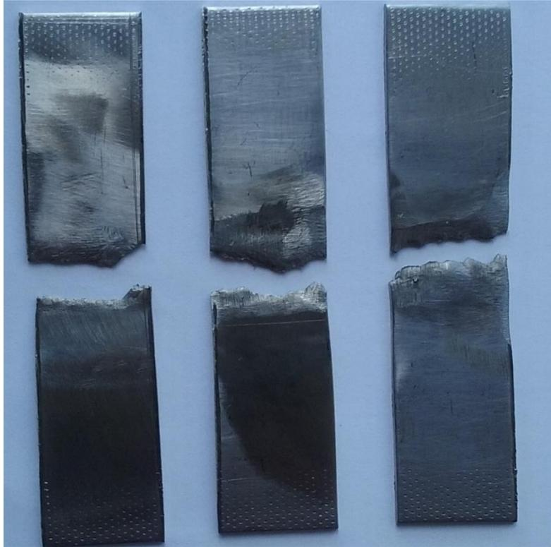
*Figura 29. Probetas de 1,5mm de espesor ensayadas a tracción. Soldadura de AISI 304L + 308L + atmosfera Argón*
