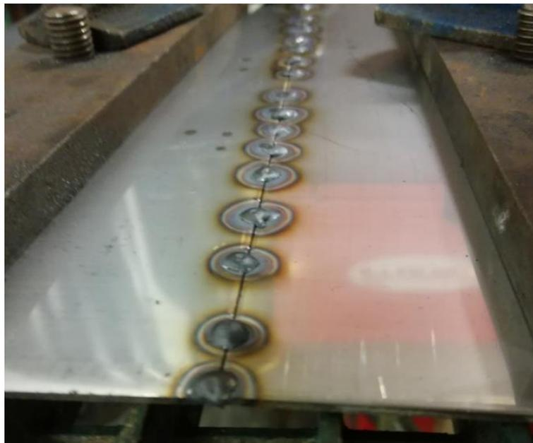
*Figura 17. Punteo de soldadura TIG con atmósfera inerte de Argón*
