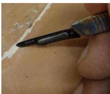
Figura 20. Imagen de detalle de prueba de limpieza físico-mecánica mediante bisturí.
