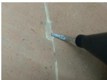
Figura 19. Imagen de detalle de prueba de limpieza físico-mecánica mediante ultrasonido.
