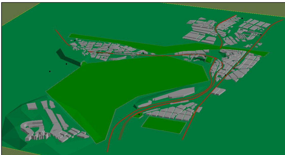
Il·lustració 10: Visió 3D del model de simulació per a soroll ferroviari
