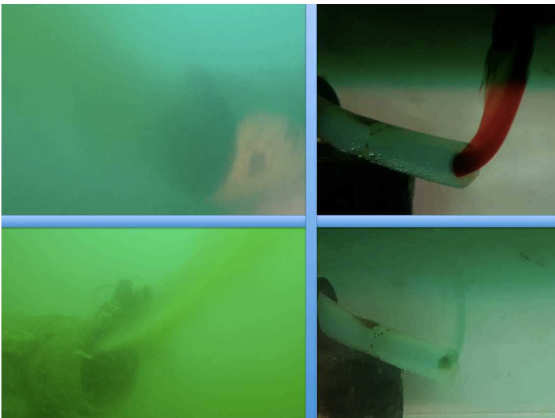
Figura 7. En estos fotogramas obtenidos a partir de los videos de las inmersiones en el emisario y del laboratorio se compara entre el emisario real y el modelo a escala vertiendo de forma proporcional (números de Froude similares). En las dos imágenes superiores se emplean los datos de la administración y la primera visita al emisario. En las inferiores los datos obtenidos de la segunda salida. Además, abajo a la izquierda se puede ver salir la leche por la parte superior de tubo, el contaminante por la zona central y la zona inferior absorber agua de mar lo que indica que en el interior del tubo el flujo es laminar hasta cortarse con la cuña salina.
