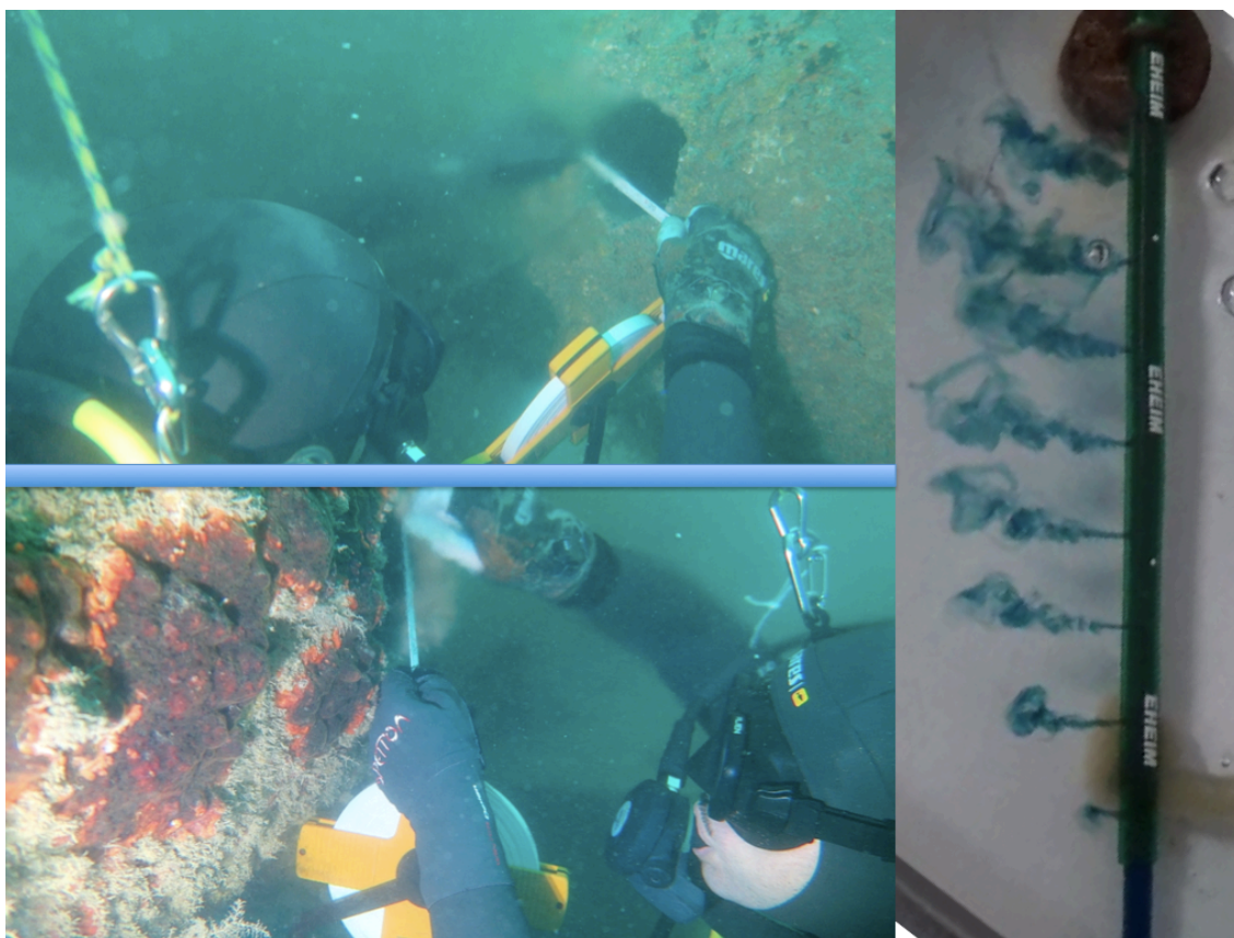
Figura 6. En estos fotogramas se aprecia la diferencia en la velocidad entre los difusores iniciales y finales. Cuando el flujo es turbulento (imagen superior) se intenta medir el diámetro de un difusor lateral donde por el cambio de densidad debido a la alta turbulencia impide ver la mano izquierda; además los organismos incrustantes son de pequeño tamaño. Cuando el flujo ha perdido carga en los difusores finales (imagen inferior) ya no es turbulento, por eso se puede observar el guante enfocado, así como los organismos colonizadores de mayor tamaño. En la imagen derecha se ve este efecto donde la velocidad va disminuyendo. Este efecto fue creado en el laboratorio sin tener en cuenta los parámetros de las aguas emitida y receptora sólo para ilustrar esta imagen.
