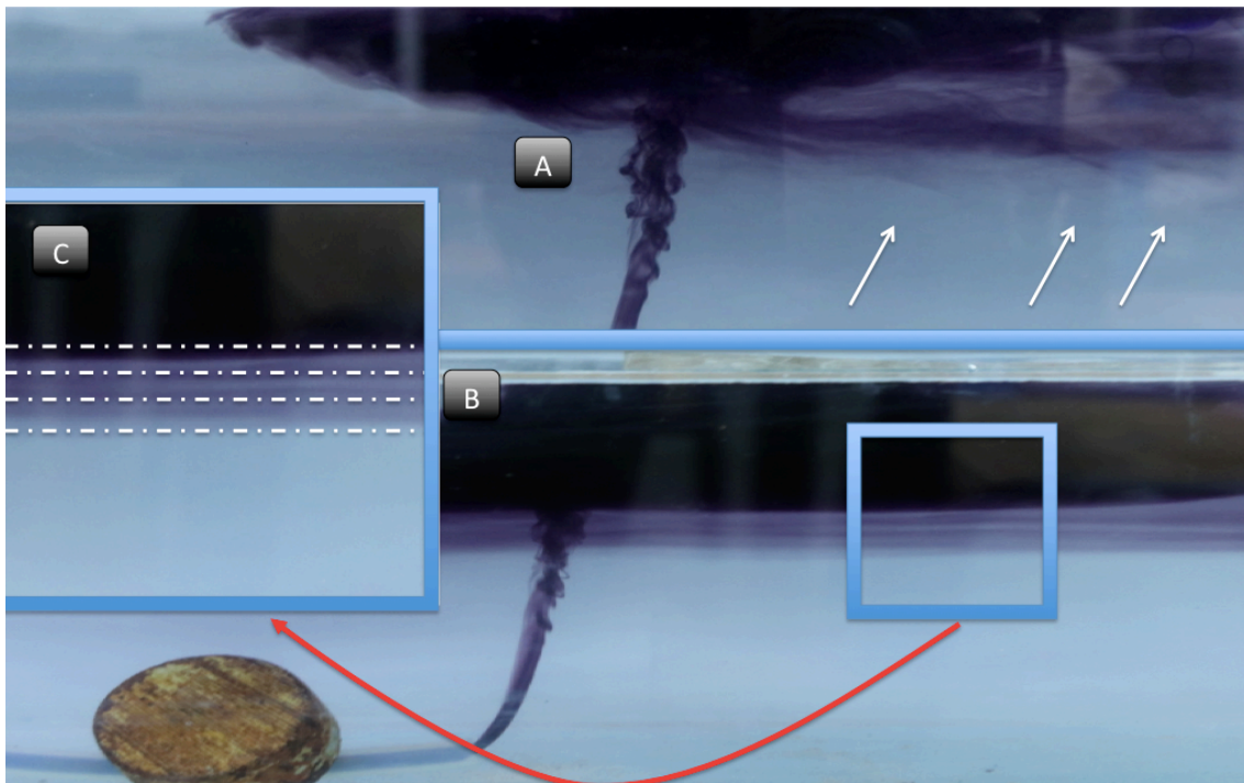
Figura14. Fotogramas de la tercera simulación. A) Pluma muy estable a pesar del viento y cizalla vertical debido a este. B) Fuerte estratificación del efluente, aparentemente sin mezclar en la capa superior, así como pequeñas capas de efluente mezclada en la picnoclina. C) Detalle de las capas de la picnoclina en seno de la onda interna.
