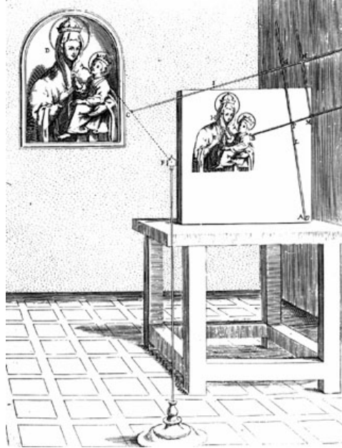
Figura 16. Scheiner, C. (s.XVII). Perspectógrafo Recuperado de: < http://www.mat.ucm.es/~jesusr/expogp/maq.html >
