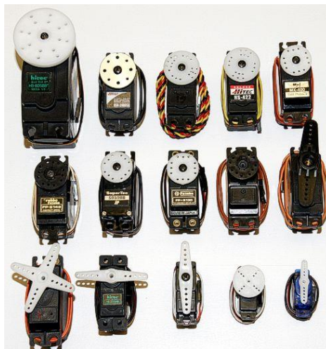
Ilustración 12 - Tipos variados de servos ( www.superrobotica.com ).
