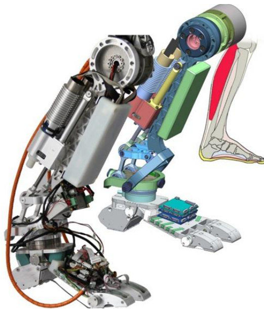
Ilustración 8 - Interpretación de una extremidad desde modelo biológico a implementación mecatrónica (Daniel Kuehn, ACTIVE SPINE AND FEET WITH INCREASED SENSING CAPABILITIES FOR WALKING ROBOTS).
