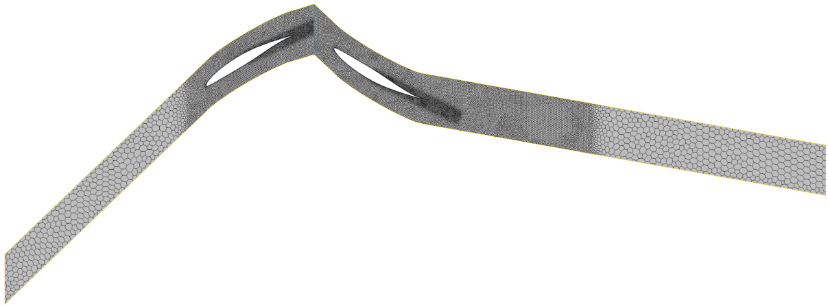
Figura 14: Malla con Refinamientos Locales
