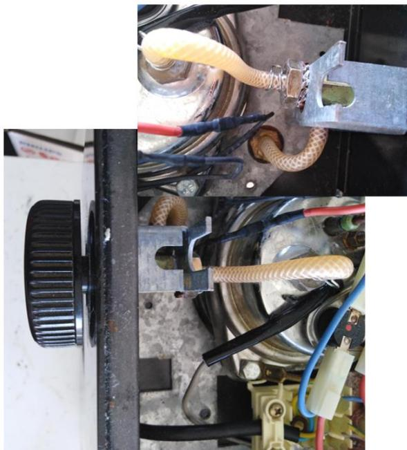
IMAGEN 32: Control de la salida de vapor
