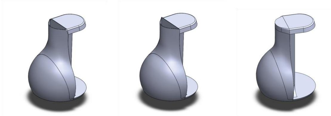
IMAGEN 72: Soluciones a la unión depósito/cuerpo en su parte superior 1
