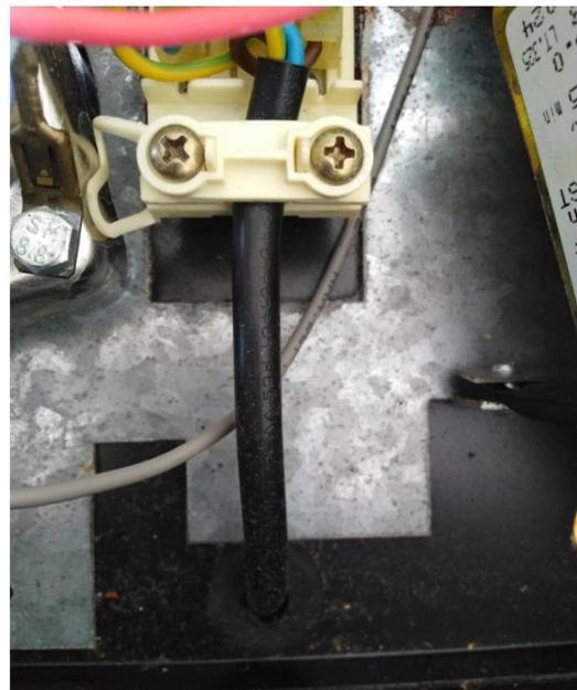
IMAGEN 31: Zona de inserción del cable de alimentación a través del depósito
