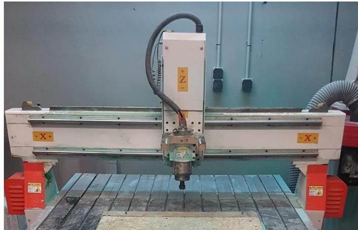
Figura 4.3: Fresadora empleada para cortar el laminado
