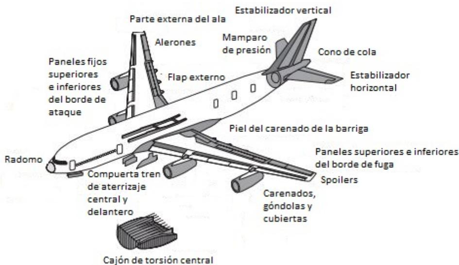
Figura 1.1: Esquema de los componentes de material compuesto en el A380 [1]
