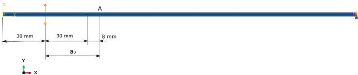
Figura 9.11: Modelo en Abaqus aumentando 3 mm la delaminación inicial
