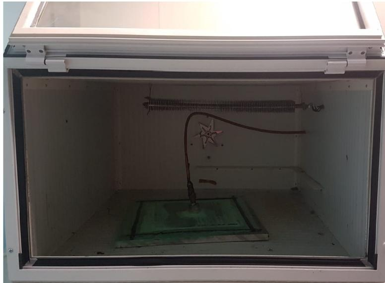
Figura 4.2: Horno de curado del laminado
