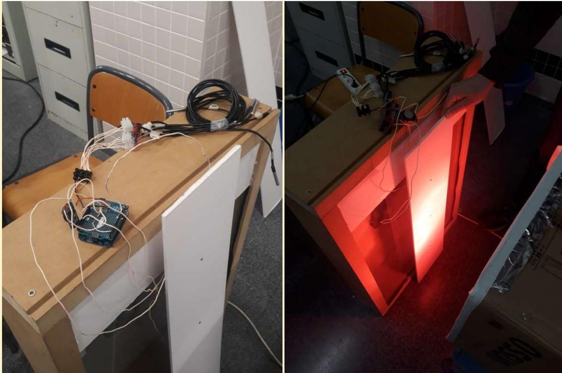
Figura 23. Dispositivo para la calibración del dispositivo de insolación.
