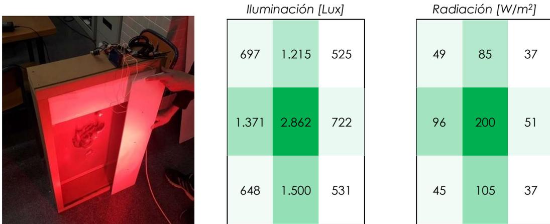
Figura 32. Iluminancia y radiación solar equivalente sobre el Muro Trombe realizados a 30 cm de distancia con incidencia de una bombilla.
