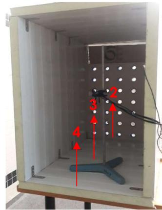
Figura 49. Puntos de medida del diseño múltiple del muro EcoCooler.
