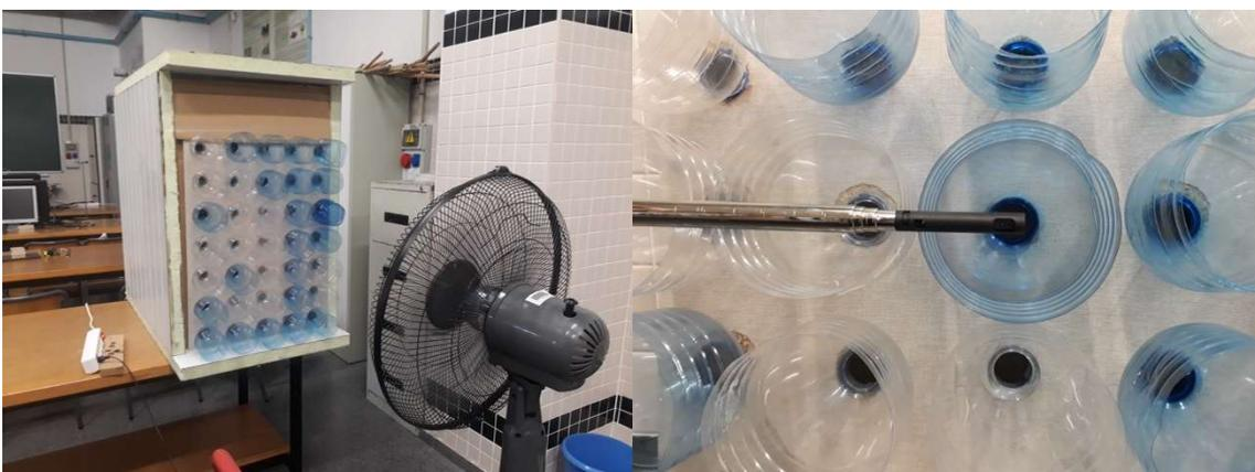
Figura 29. Control de flujo de aire en diseño múltiple del muro EcoCooler.
