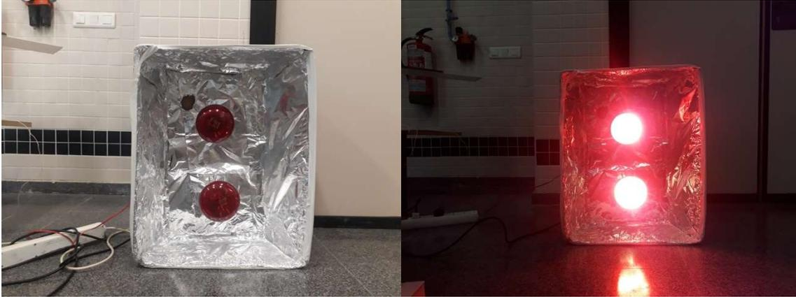
Figura 22. Dispositivo para control de insolación de muro Trombe en condiciones de laboratorio.
