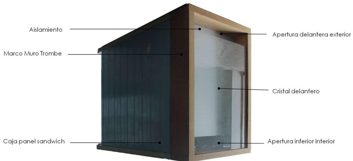
Figura 6. Aspecto final del muro Trombe construido.
