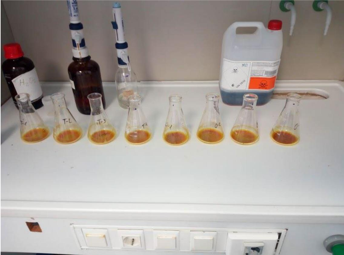
Figura 19. Valoración de la materia orgánica utilizando dicromato potásico y ácido sulfúrico concentrado. (elaboración propia)
