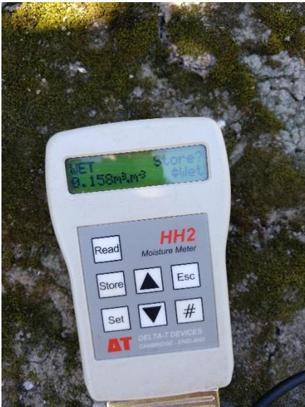
Figura 22. Sensor de humedad HH2(elaboración propia).
