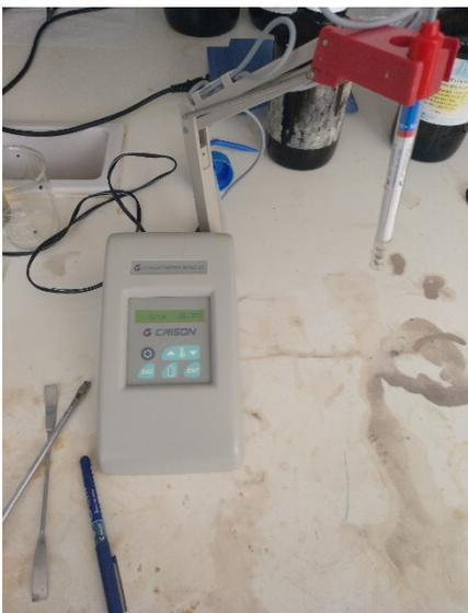
Figura 15. Conductímetro(elaboración propia)
