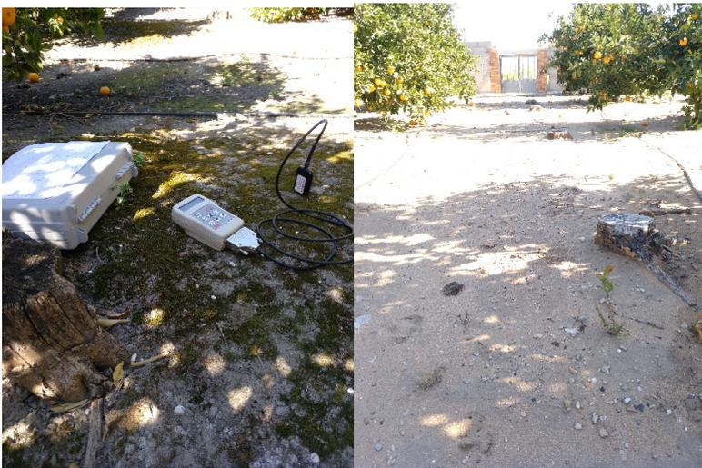
Figura 23. Medición con el sensor de humedad. (elaboración propia)
