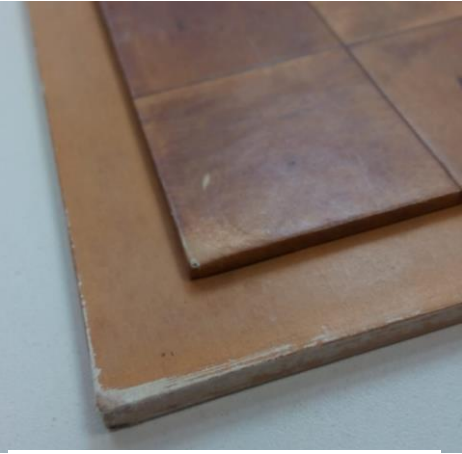
Fig. 15 Esquina deteriorada por la acción mecánica al abrir la caja.
