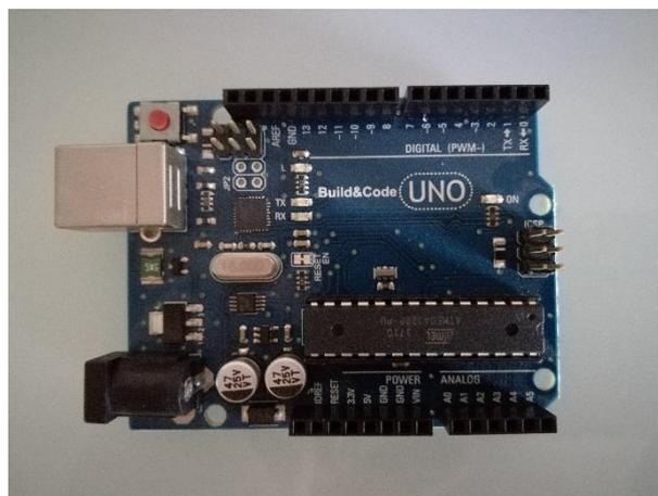
**Figura 2. Placa Build&Core UNO R3**
