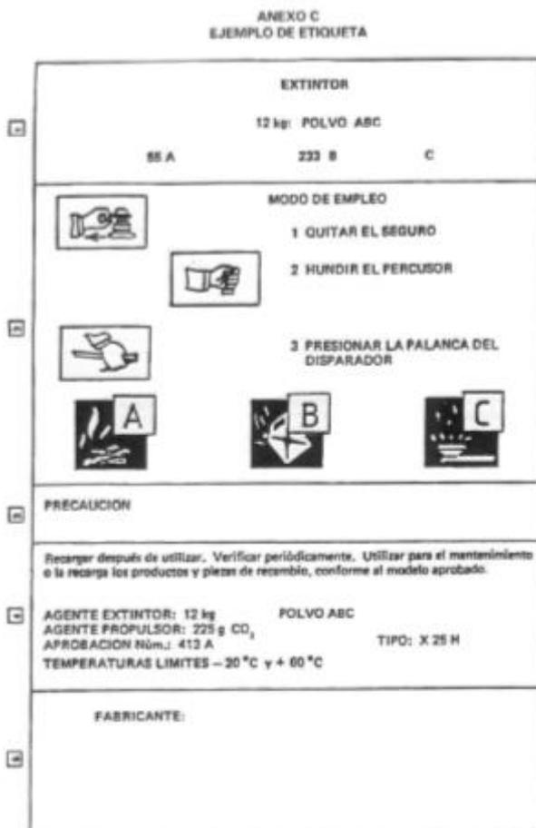
Figura 17. Ejemplo de etiqueta de un extintor
