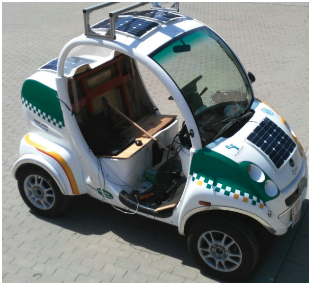
Figura 1: eCARM: vehículo eléctrico usado como banco de pruebas.
