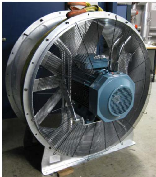
Figura 2.9: Ventilador del túnel de viento [2].
