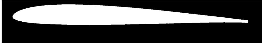
(b) Imagen de los contornos rellenos del perfil aerodinámico SD 7003. Esta imagen se ha obtenido tras aplicar un filtro de tamaño sobre el ruido.
