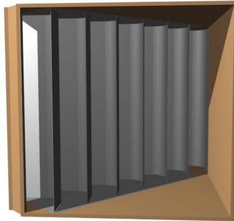
Figura 2.10: Codo del túnel de viento [2].
