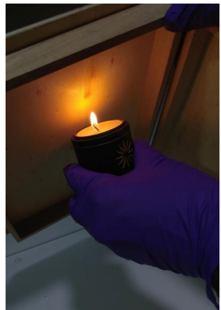
Figura 18. Aplicación de la llama por el anverso. Figura 19. Aplicación de la llama por el reverso.
