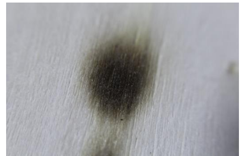
Figuras 20 y 21. Fotografías de las quemaduras vistas por una lente macro por el anverso y reverso.
