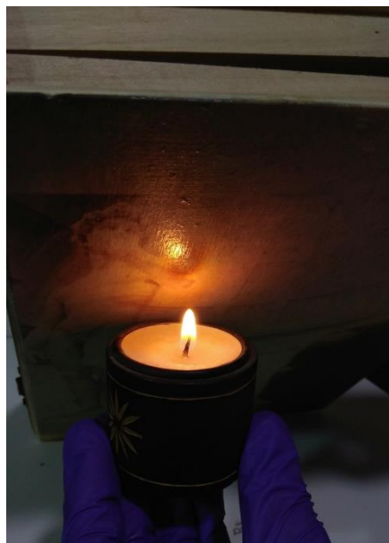
Figura 18. Aplicación de la llama por el anverso. Figura 19. Aplicación de la llama por el reverso.
