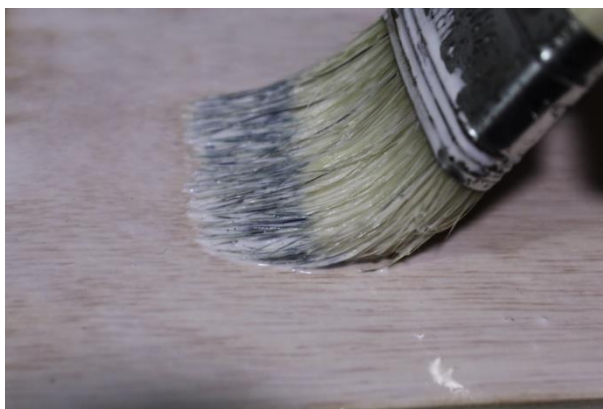
Figura 26. Aplicación del acetato de polivinilo sobre la madera.
