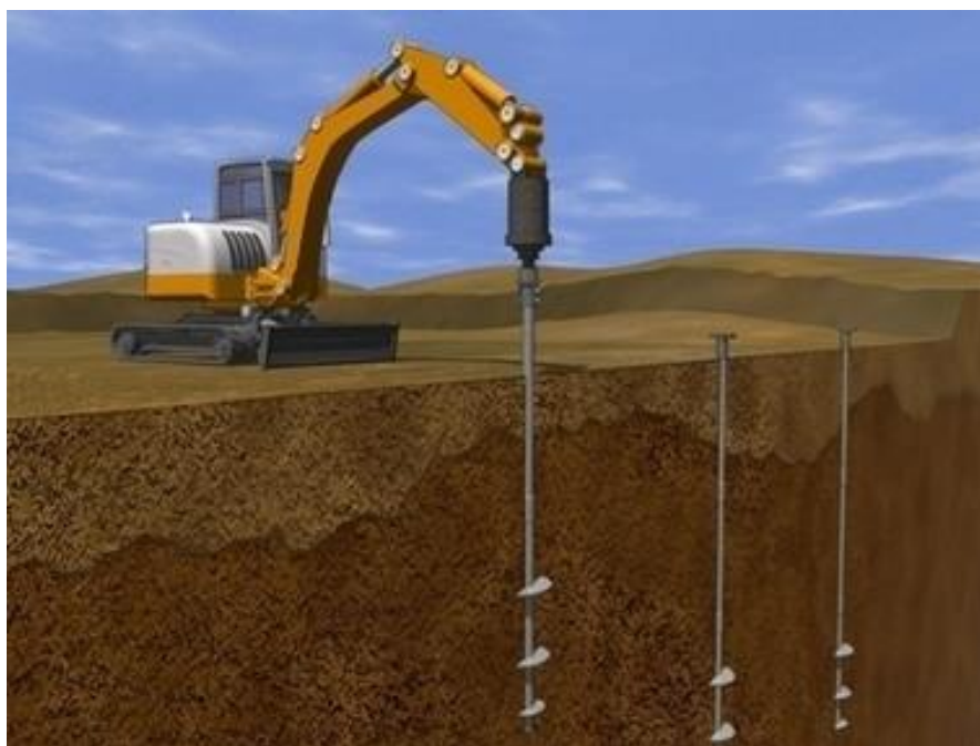
Figura 7. 11. Pilotes perforados mediante hélice. ( https://victoryepes.blogs.upv.es/tag/pilotes-helicoidales/ ).
