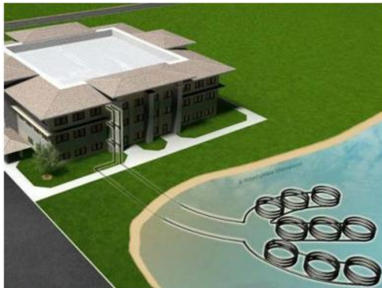
Figura 4. 12. Intercambiadores horizontales sumergidos. (www.waterfurnace.com).
