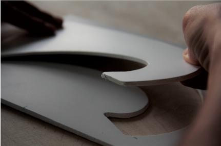
Se eligió el material conocido como *Forex* – planchas de PVC expandido. Es ligero y resistente, además, se corta fácilmente con un cúter y se puede lijar con una lija fina. Para empezar, se imprimen los esquemas vistos anteriormente, cada una de las olas en una hoja a tamaño real; las hojas se pegan sobre la plancha de *Forex* de 3 milímetros de grosor y se recortan con un cúter.
