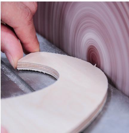
Con el producto ya ensamblado y la cola seca, se eliminan los restos de cola blanca con una lija fina y a continuación, se le aplica al portacuchillos la segunda capa de aceite.
