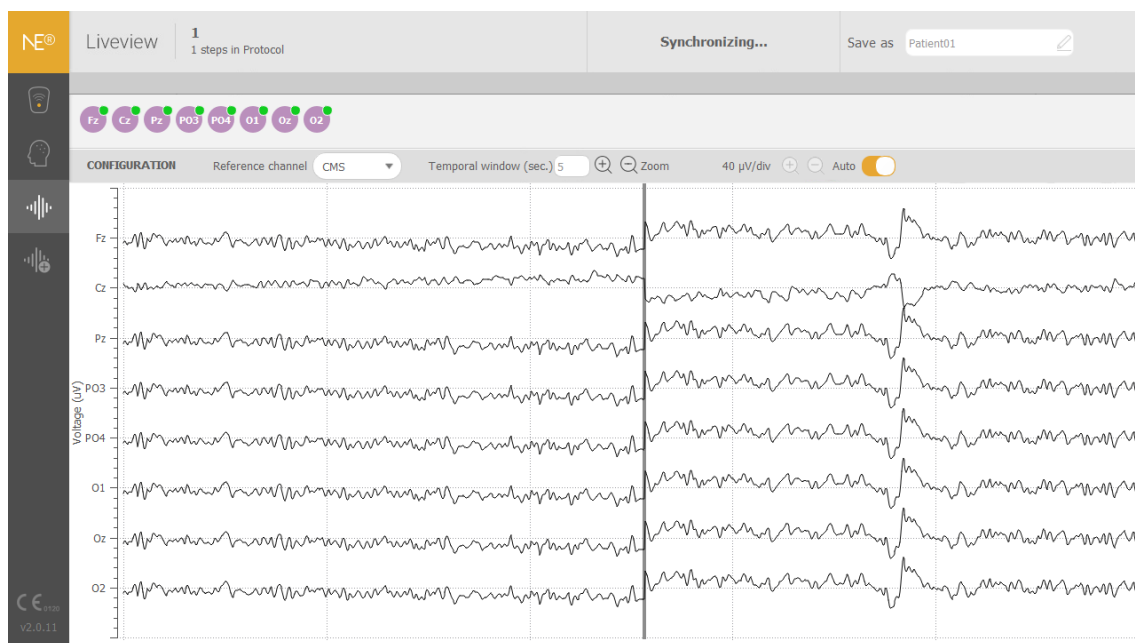
Figura 44. Verificación del funcionamiento de los electrodos, NIC2
