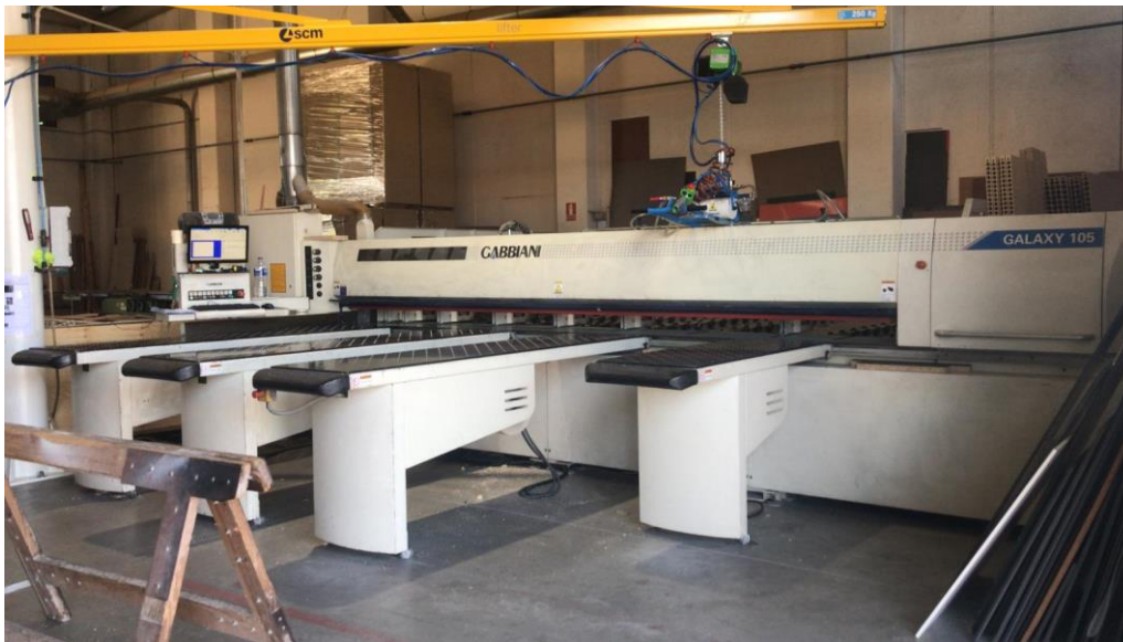
Ilustración 3.2.1 Seccionadora utilizada por empresa maderera.
