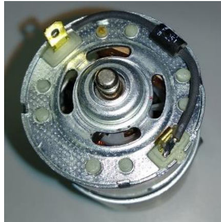
Ilustración 4.2.14 Conexión de diodo en anti-paralelo al motor de corriente continua.
