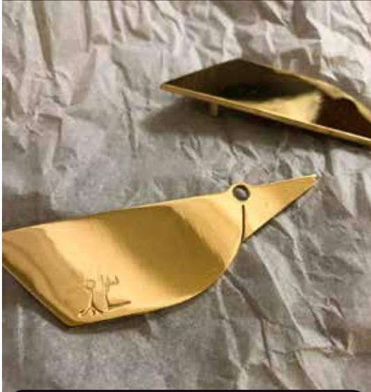
Las piezas de latón se cortan utilizando como patrón las piezas de metacrilato cortadas por láser.
