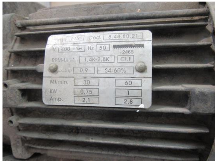
Fotografía 20. Sierra de cinta y placa características.
