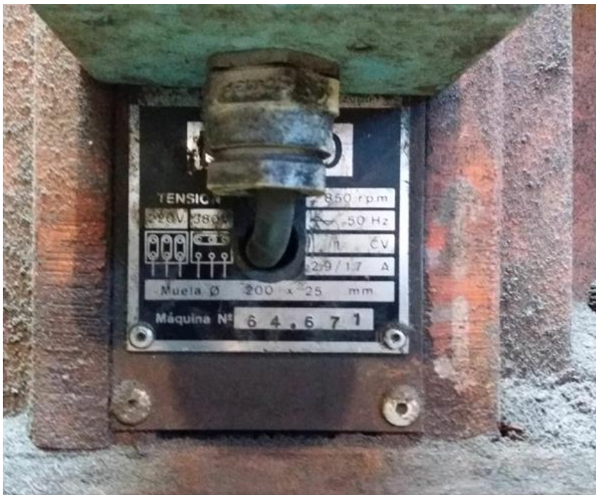
Fotografía 26. Esmeriladora grande y placa características.
