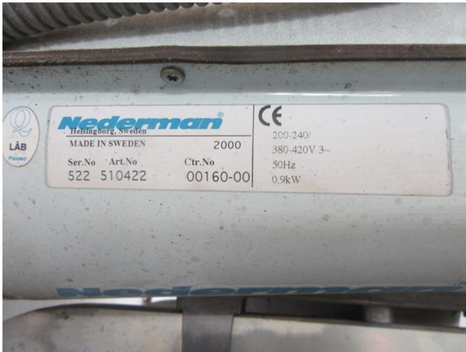
Fotografía 32. Extractor de humos de soldadura y placa características.
