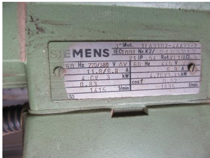
Fotografía 22. Taladradora de columna y placa características.
