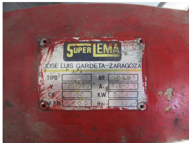
Fotografía 25. Esmeriladora pequeña y placa características.
