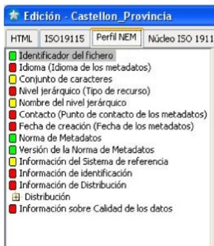
Figura 10-Datos requeridos para el perfil NEM, en rojo los obligatorios y en amarillo los condicionales.-Elaboración propia.
