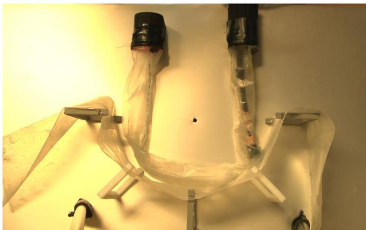
Fig. 41 Ensayo con intestino y pared abdominal. En la imagen se aprecia como el sistema Endoworm choca con la pared abdominal, impidiendo su avance más allá de los límites. Se mantiene la curva del intestino.
