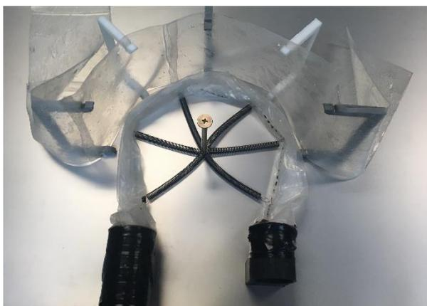
Fig. 29 Montaje de intestino curvo y muelles, con pared
