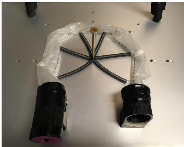
Fig. 28 Montaje del intestino curvo y muelles (sin pared)
