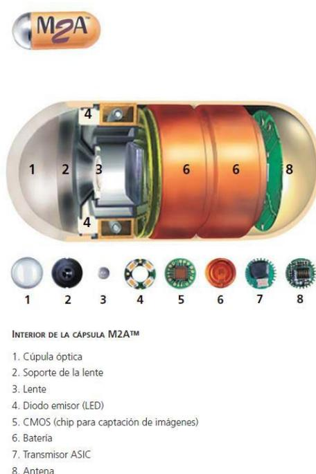
Fig. 9 Cápsula endoscópica [19]
