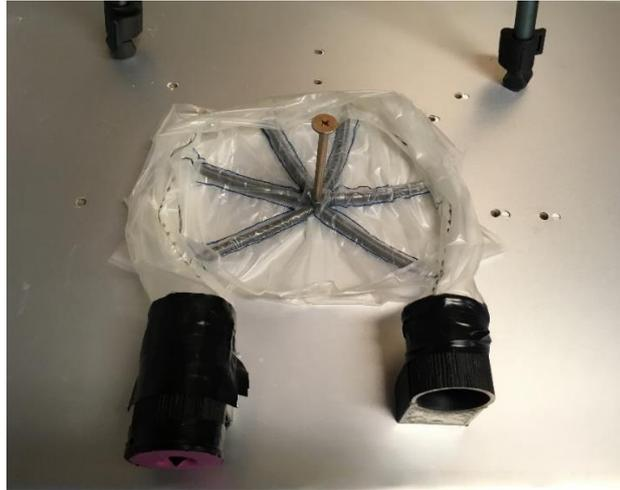
Fig. 30 Montaje del intestino, muelles y membrana (sin pared)
