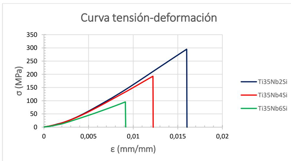
Gráfica 4.3.4. Curva tensión-deformación de las aleaciones de Ti-35Nb-XSi (X=2, 4 y 6).
