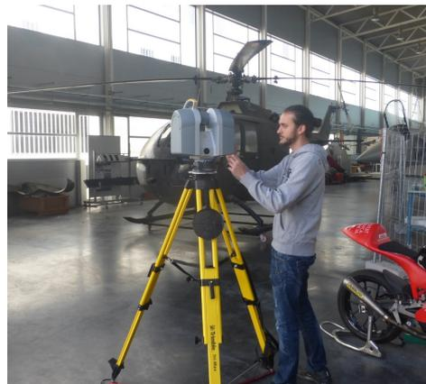
Figura 6.2: Trimble TX6 siendo configurado para realizar un escaneo
