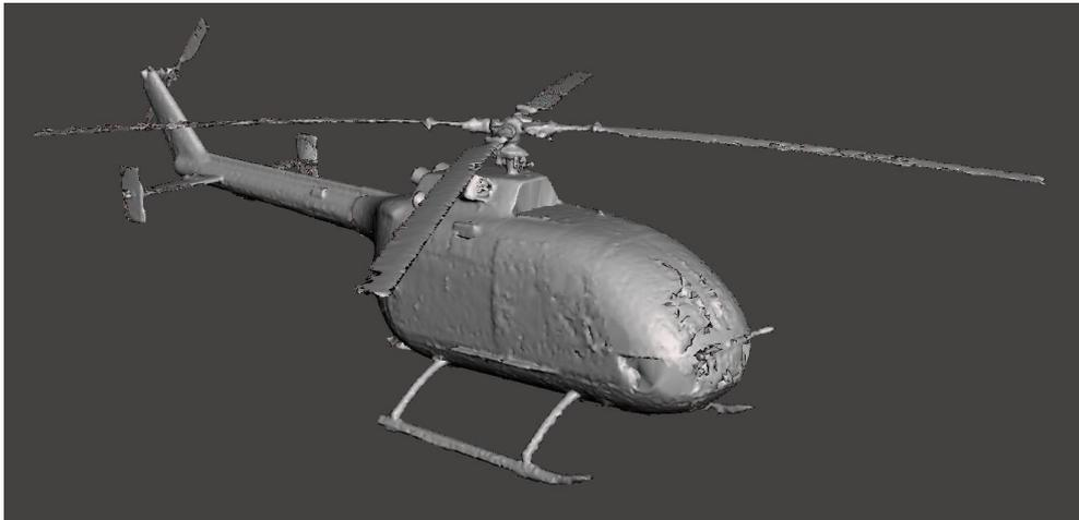
Figura 7.30: Malla reparada abierta en Meshmixer
