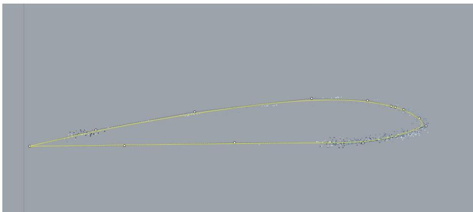
Figura 7.46: Perfil de la pala obtenido por ingeniería inversa
