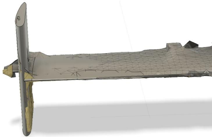
Figura 7.38: Comparación entre malla y modelado del estabilizador
