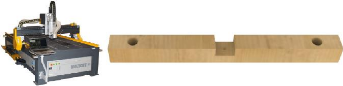
Ilustración 119 : proceso de fresado del elemento de refuerzo superior
