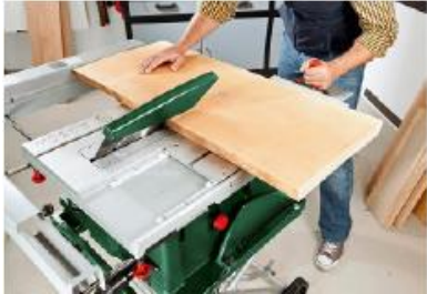
Ilustración 114 : proceso de corte del tablero de pino
