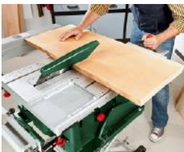
Ilustración 118 : proceso de corte del refuerzo superior del taburete
