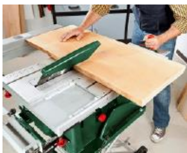
Ilustración 121 : proceso de corte del refuerzo superior de la mesa
