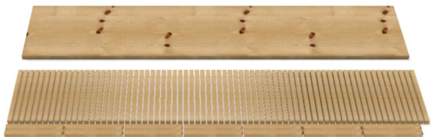
Ilustración 118 : proceso de corte del refuerzo superior del taburete
