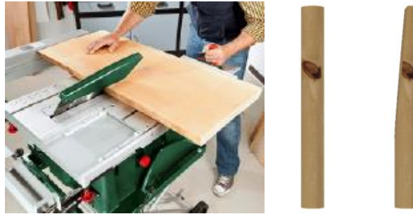
Ilustración 131: proceso de corte sección pata
