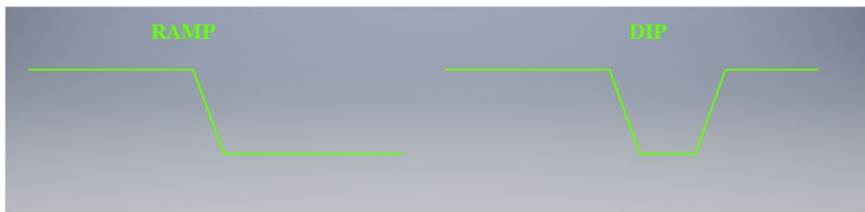
Figura 7.11: Representación esquemática de las vías con perturbación de tipo 'ramp' (izquierda) y 'dip' (derecha)
