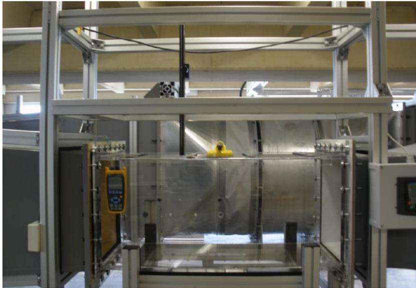
Figura 24. Sistema de posicionamiento de sonda en DMMT UPV.
