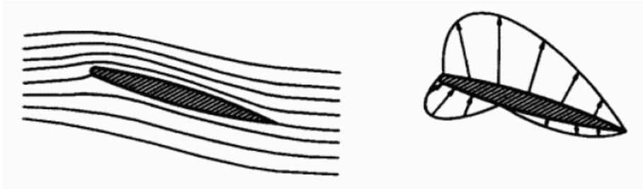
Figura 9. Distribución de presiones perfil simétrico con ángulo de ataque positivo
