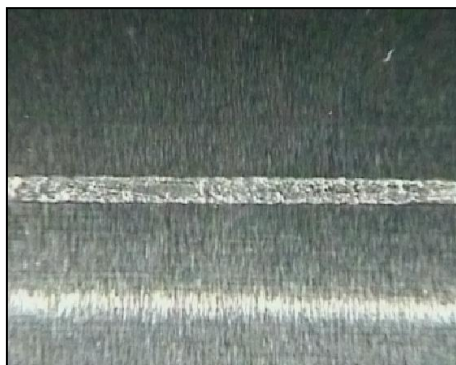
Fig. 47: Desgaste de la guía [9]
