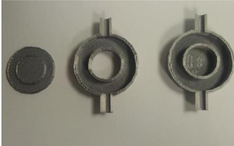
**Figura 12.** Resultado de las piezas impresas con PLA en impresora 3D
