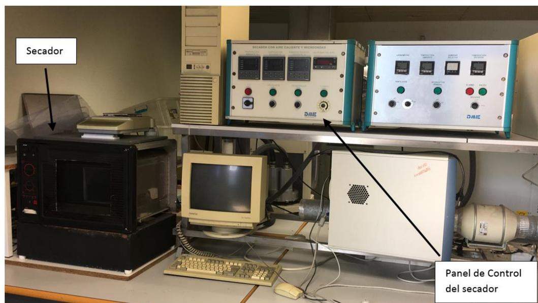
**Figura 6:** Montaje utilizado para la operación de secado
