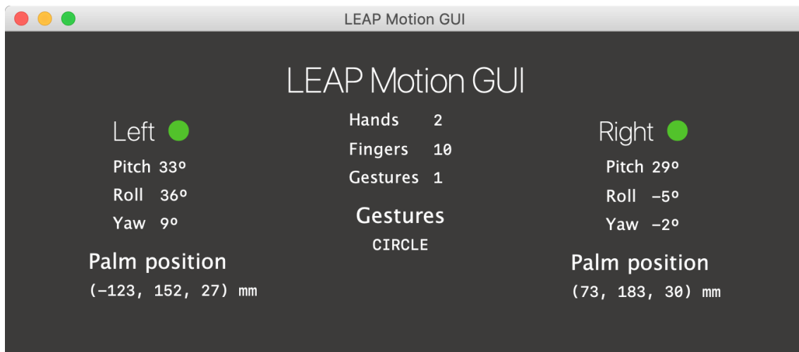
Figura 18: Captura de la aplicación LEAPMotion_Window cuando las dos manos están insertadas y se detecta el gesto CIRCLE
