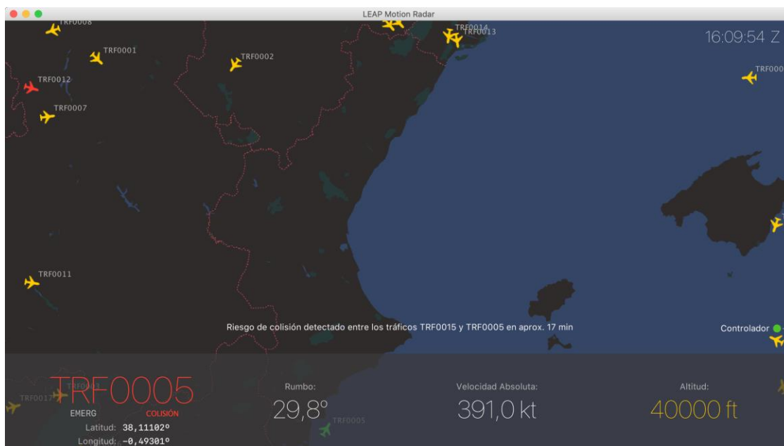
Figura 38: Vista del panel de información de un tráfico sintético en riesgo de colisión, con el usuario cambiando la altitud del mismo
