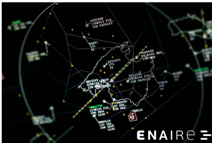
Figura 5: Vista radar del SACTA (Fuente: enaire.es)
