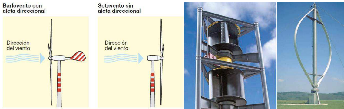
Figura 14. Aerogeneradores a barlovento, a sotavento, Savonius y Darrieus. Fuente: [17]
