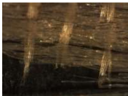
Imagen 20 Cíngulo visto con Microscopio estereoscópico en el que se aprecia la desnaturalización de la seda (x80)
