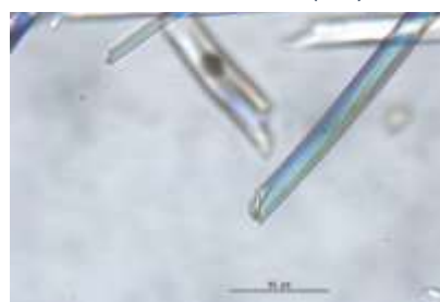
Imagen 21 Fibras de seda del Cíngulo vistas con Microscopio óptico binocular donde se aprecia una de las fibras quebradas de la seda. (x400)
