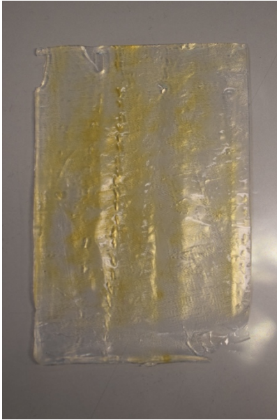
Figura 34. Resultado de la primera limpieza del interior de la pala derecha con placa de agarosa
