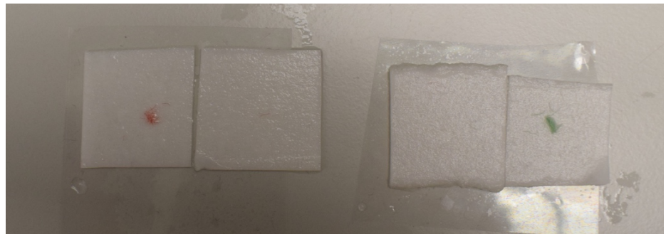
Fig 24. Pruebas de solidez de tintes, Fibras del labrado de lana de las tramas rojas y verdes
