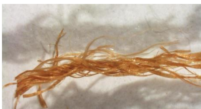
Figura 27. Fotografía \times 80 aumentos, hilo desintegrado.
