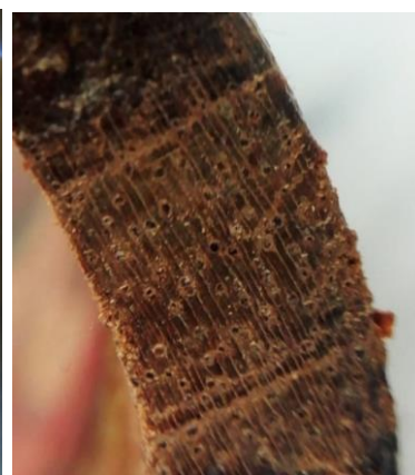
Figura 36. Detalle de la zona del soporte leñoso después de realizar la limpieza de colas.
