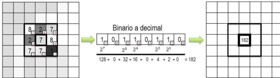
Figura 3.10. Principio básico que siguen los métodos basados en LBP.
