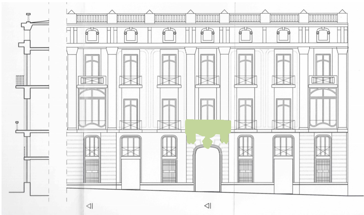
Figura 4. Fotografía del croquis realizado por el arquitecto en el momento de plantear la intervención. A el se le ha sumado un recuadro verde con el espacio a intervenir.
