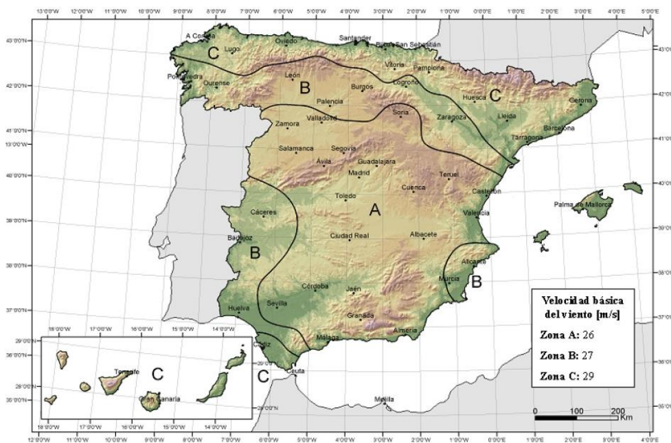
Figura 17: Valor básico de la velocidad del viento, vb. Figura D.1 del CTE DB SE-A.
