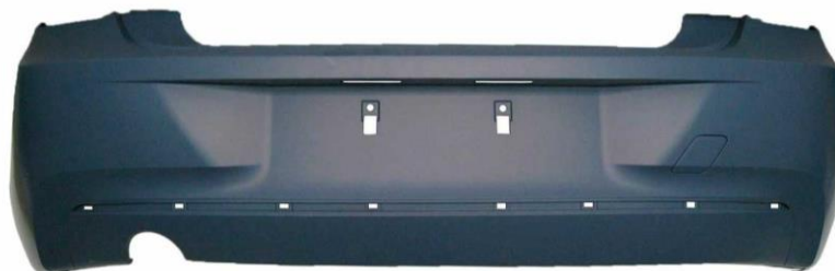
Fig. 6: Paragolpes trasero con tratamiento previo a pintura.
