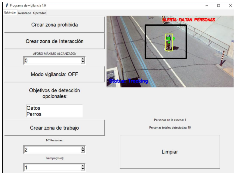
Figura 14.1.1.10. Funcionamiento de la zona de trabajo.
