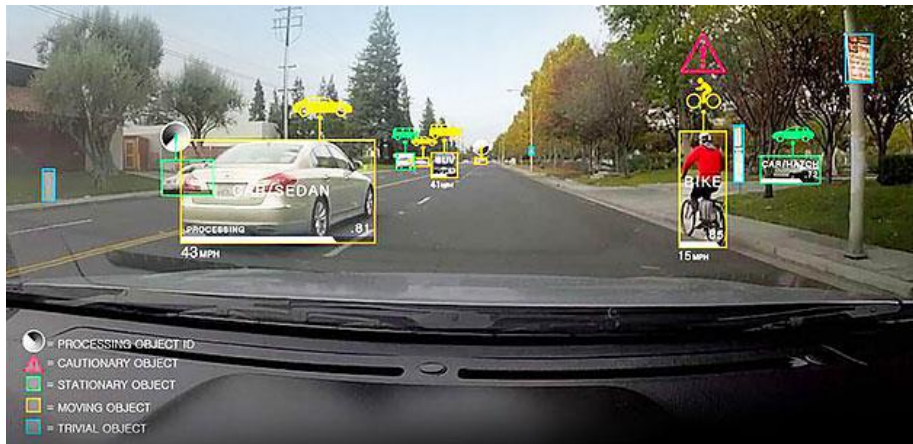
Figura 3.2.5. Sistema de detección y reconocimiento en un coche autónomo por NVIDIA AI Labs.
