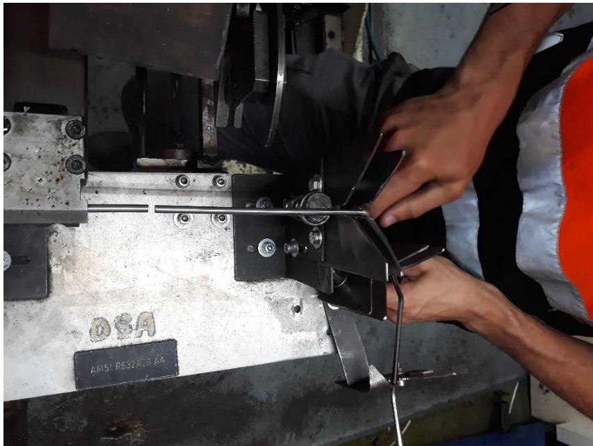
Figura 26. Ajustes manuales sobre el utillaje.
