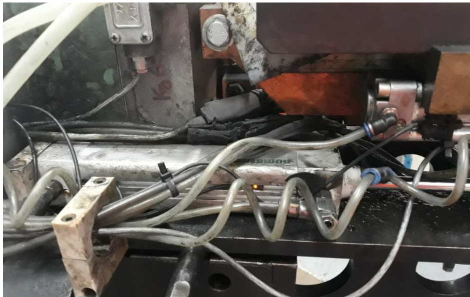
Figura 37. Actuador neumático accionador brazo extensible.
