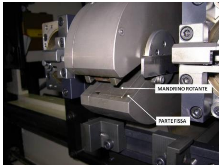
Figura 12. Cabezal central o gripper de CNC Turbobender.
