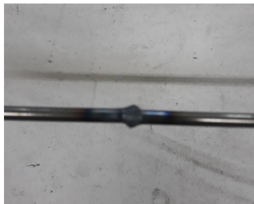
Figuras 17 y 18: Comprobación de piza en galga. Soldadura OK.
