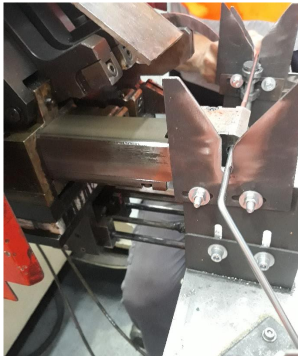
Figura 23. Movimientos brazo extensible y mordaza.
